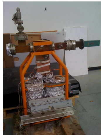
Klystron 40 MW, 4 \mu s pulse
