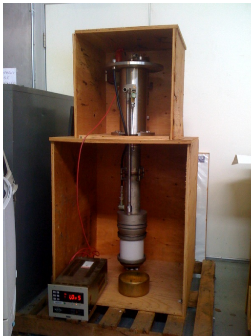
Klystron 40 MW, 4 \mu s pulse
