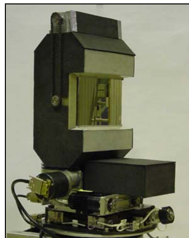
Fig. 9. A Heusler ( \text{Cu}_2\text{MnAl} ) monochromator.
