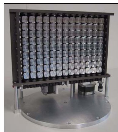
Fig. 7. Double Focusing HOPG(002) monochromator.
