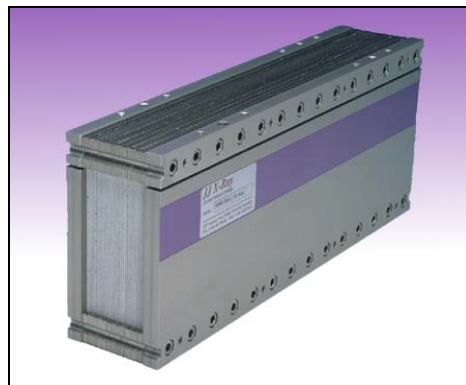
Fig. 21. A linear Soller collimator.
